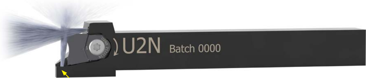
Einrichtungstipp: Verwenden Sie den Werkzeughalter als Stangenanschlagfläche. Abstichposition = t + Abschnittbreite
